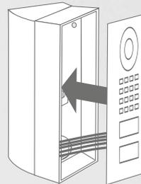
Setzen Sie die Frontblende inklusive der elektrischen Haupteinheit auf das Rückgehäuse.
