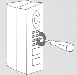
Drehen Sie die Sicherheitschrauben im Uhrzeigersinn bis sie festgezogen sind.
