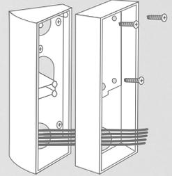
Verschrauben Sie das Rückgehäuse mit dem Adapter.
