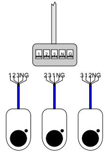
Bei der Installation mehrerer Geräte die Phasen des jeweils ersten, zweiten und dritten Chargers rotierend entsprechend der nebenstehenden Abbildung mit dem Hausstromkreis verbinden, um eine gleichmäßige Lastverteilung beim Laden von einphasigen Fahrzeugen zu erhalten. **Hinweis:** Für statisches Lastmanagement wird die go-eCharger App benötigt.
