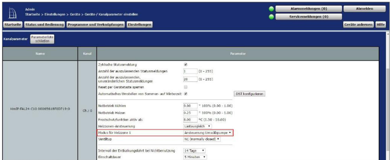
Abbildung 227: Konfiguration Kanalparameter Fußbodenheizungsaktor
