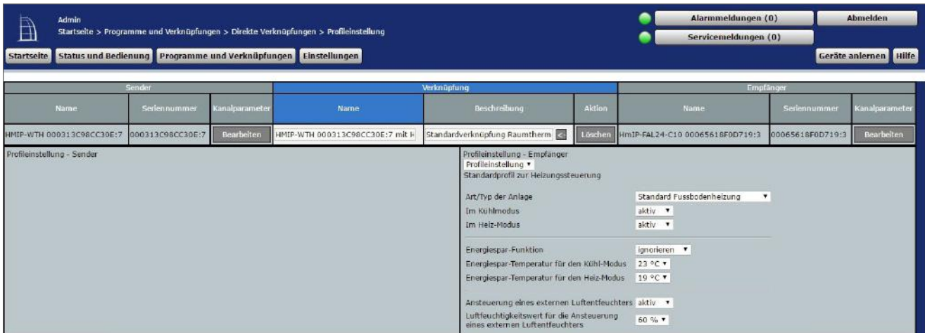
Abbildung 215: Verknüpfungparameter zwischen Wandthermostat und Fußbodenheizungsaktor
