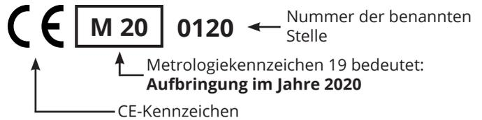
**Dieses Produkt ist für Verrechnungszwecke nach EG Baumusterprüfbescheinigung Nummer 0120 / SGS0261 Anhang B und Anhang D der SGS United Kingdom Limited (Benannte Stelle 0120) zugelassen.**
