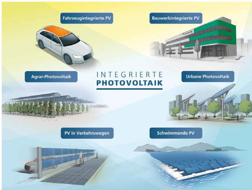
Abbildung 30: Anwendungen für die Integration von Photovoltaik
